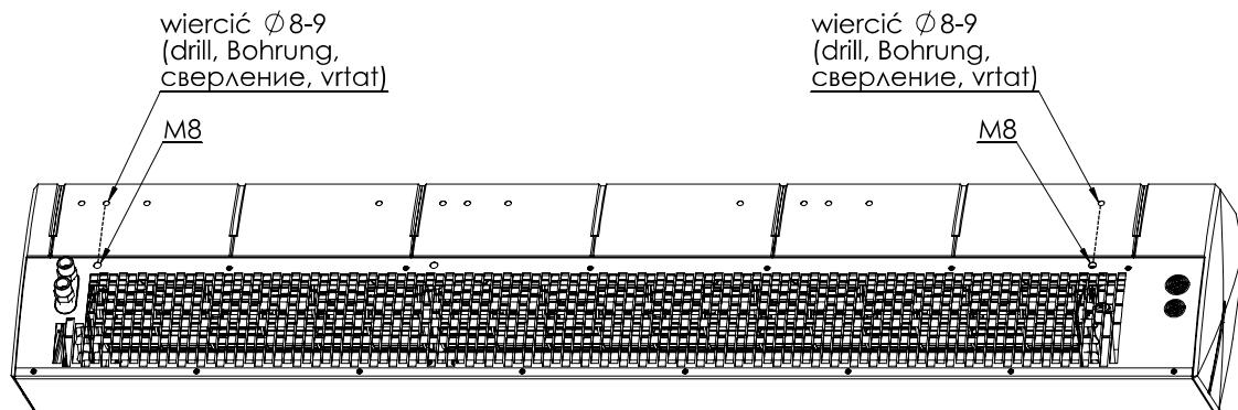
На рис. указаны монтажные втулки под шпильки.
