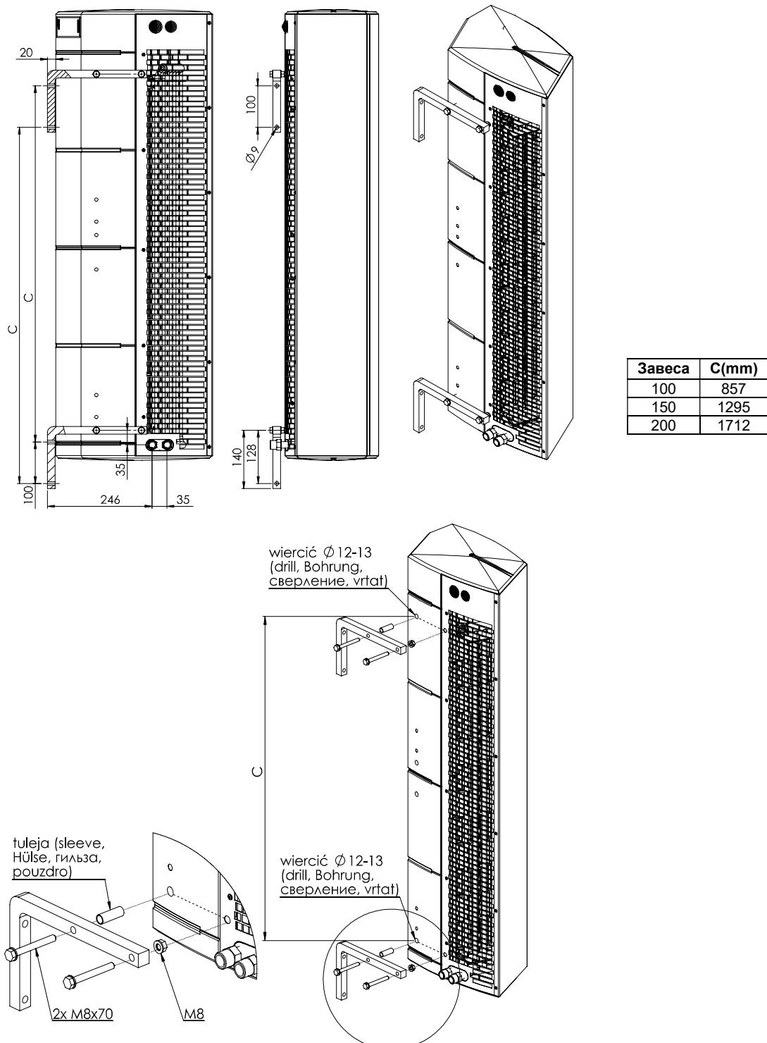
Важно, чтобы минимальное расстояние от пола до завесы составляло не менее 100 мм. Это позволит получить доступ к электрической клеммной колодке и вентилятору при монтаже завесы с двигателем внизу.
